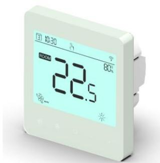
Vision+ permette di programmare la temperatura ambiente con 4 cambi di temperatura per ogni giorno della settimana, sia in caldo che in freddo.
